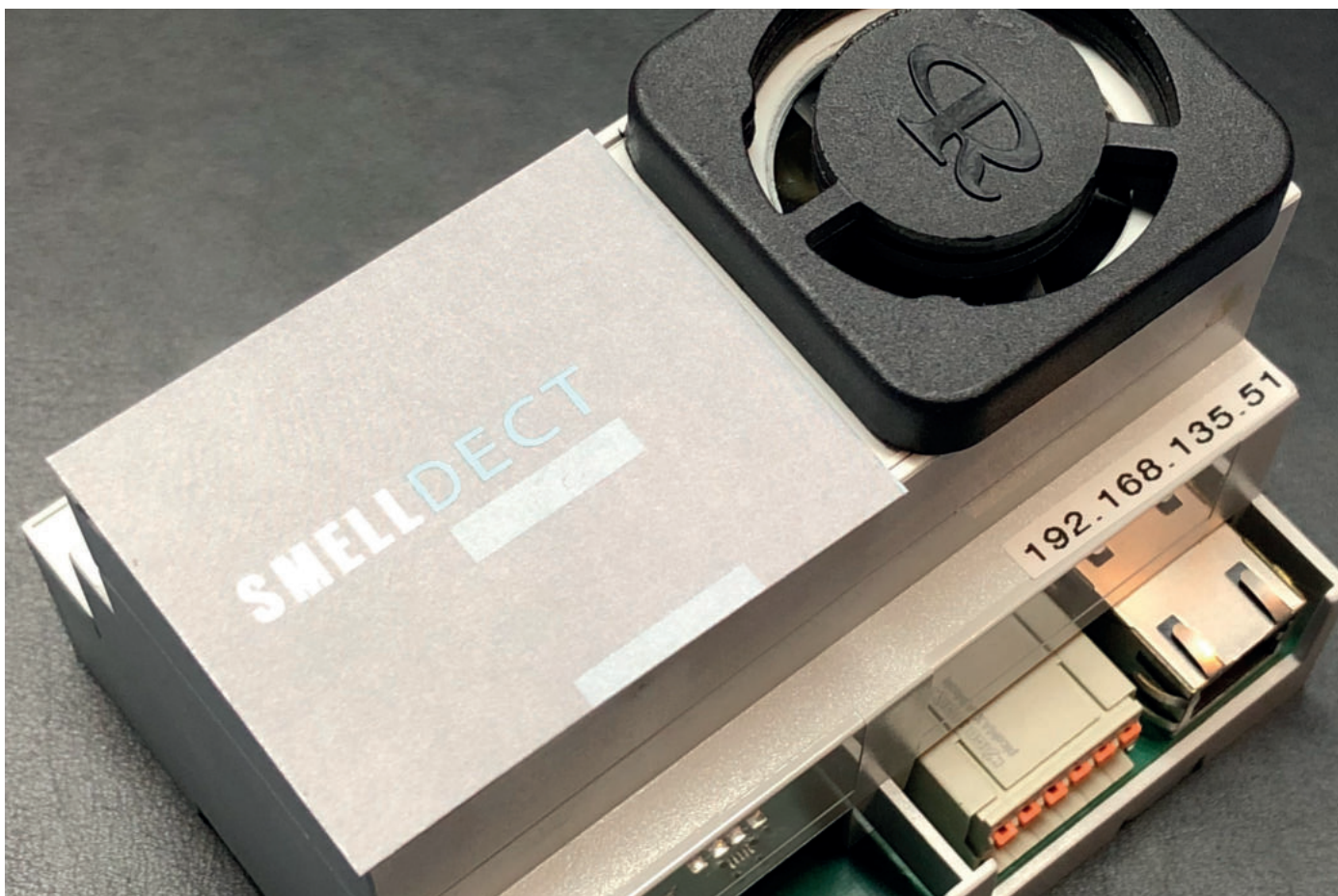
Die SMELLDECT GmbH ist zuständig für Fertigung und Vertrieb der eNase – ein kleines Gerät, das aus Chip, Elektronik und Lüftung besteht: Hier als ansteckbares Brandwächter-Modul für Computerschränke. Foto: SMELLDECT
