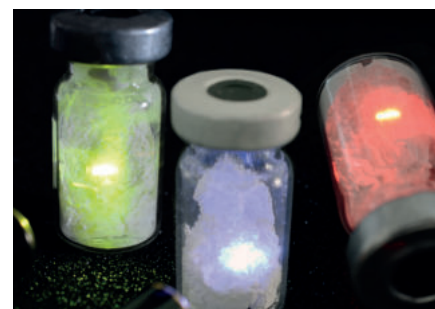
Fluoreszierende Markerpartikel werden in kleinsten Mengen auf eine Verpackung aufgetragen und können in der Sortieranlage identifiziert werden. Foto: Polysecure
