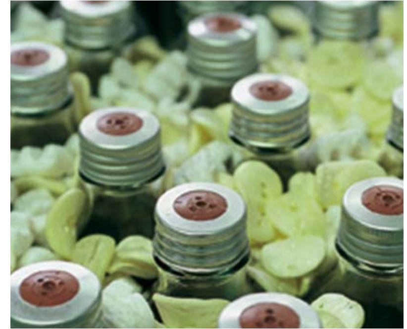
Anaerober Abbauteest nach OECD 311 / Anaerobic decomposition test
