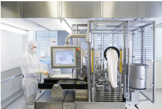
Dieser Teil der GMP-Anlage von CureVac ist die Abfüllanlage mit der höchsten Reinraumklasse A.
