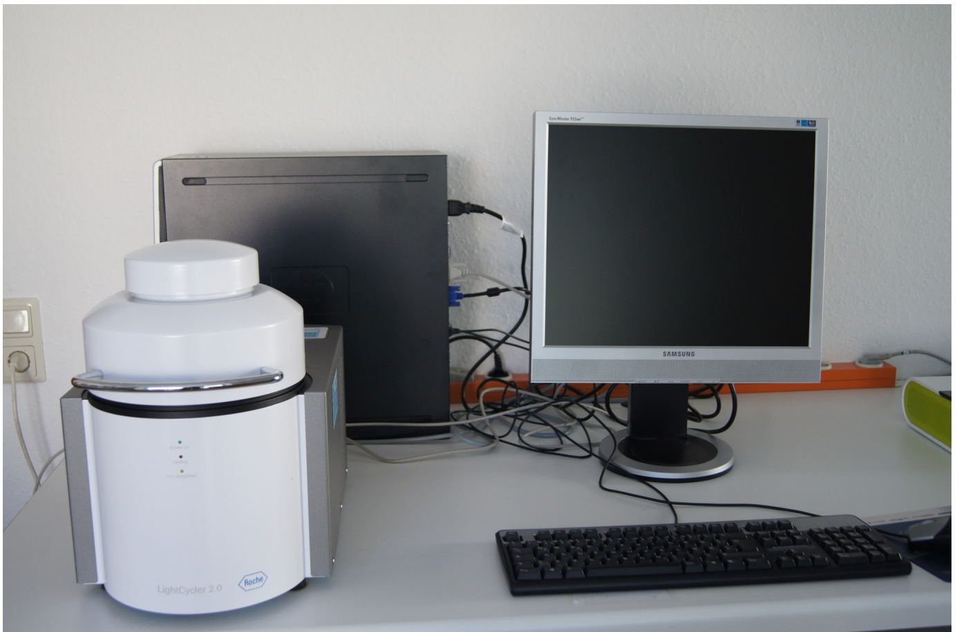
Im hauseigenen Real-Time-PCR-Gerät entwickelt und optimiert Dr. Sabine Lautenschläger PCR-Tests für ihre Kunden. © Sabine Lautenschläger / dsl-Labor
