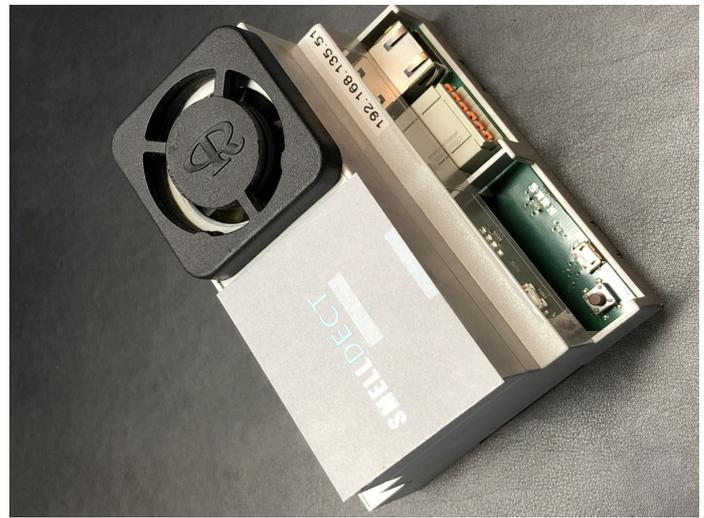
Die SMELLDECT GmbH ist zuständig für Fertigung und Vertrieb der eNase - ein kleines Gerät, das aus Chip, Elektronik und Lüftung besteht: Hier als ansteckbares Brandwächter-Modul für Computerschränke.
