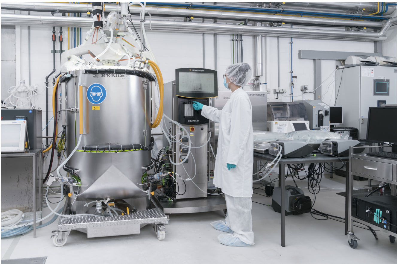
Der Faktor H von eleva wird in 1001-Wave-Reaktoren im Reinraum produziert. © eleva GmbH
