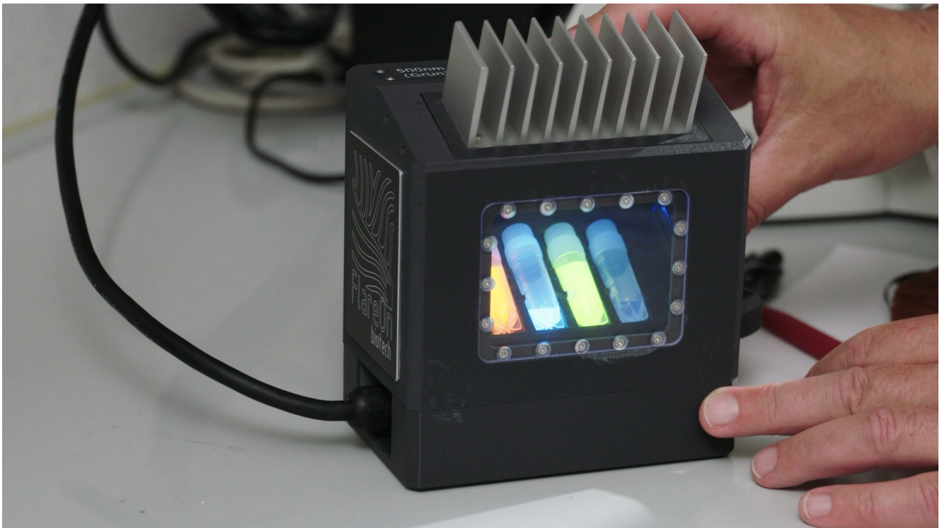
Sensor löst Farbreaktion aus: Tumorzellen leuchten im UV-Licht, bei gesundem Gewebe bleibt die Reaktion und somit das Leuchten aus. © FlareOn Biotech GmbH
