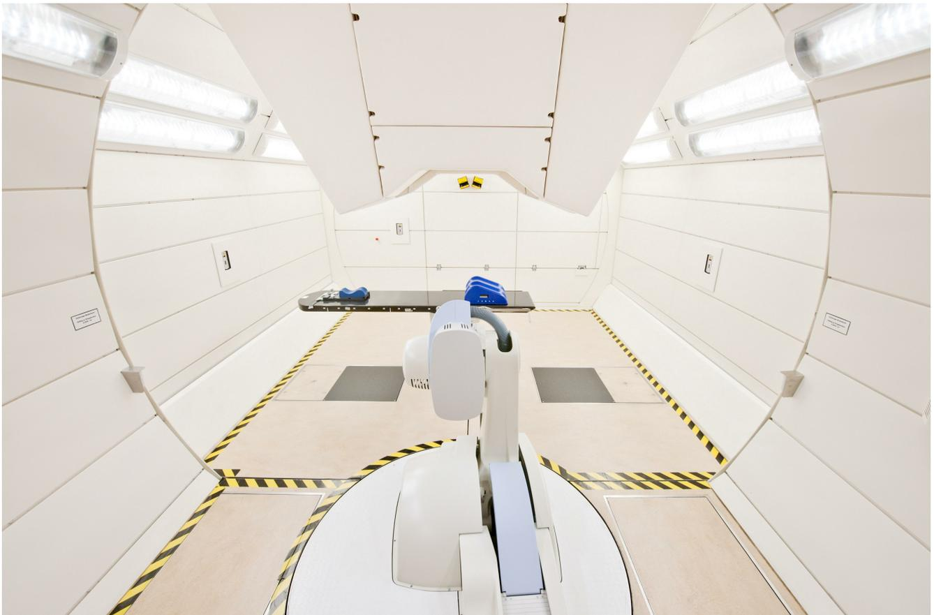
Bestrahlungsraum mit einer um 360° drehbaren Bestrahlungsquelle, der sogenannten Gantry. So kann der Ionenstrahl aus jeder Richtung auf den Tumor gelenkt werden. Es gibt am HIT noch zwei weitere Behandlungsplätze mit fester horizontaler Strahlführung.
