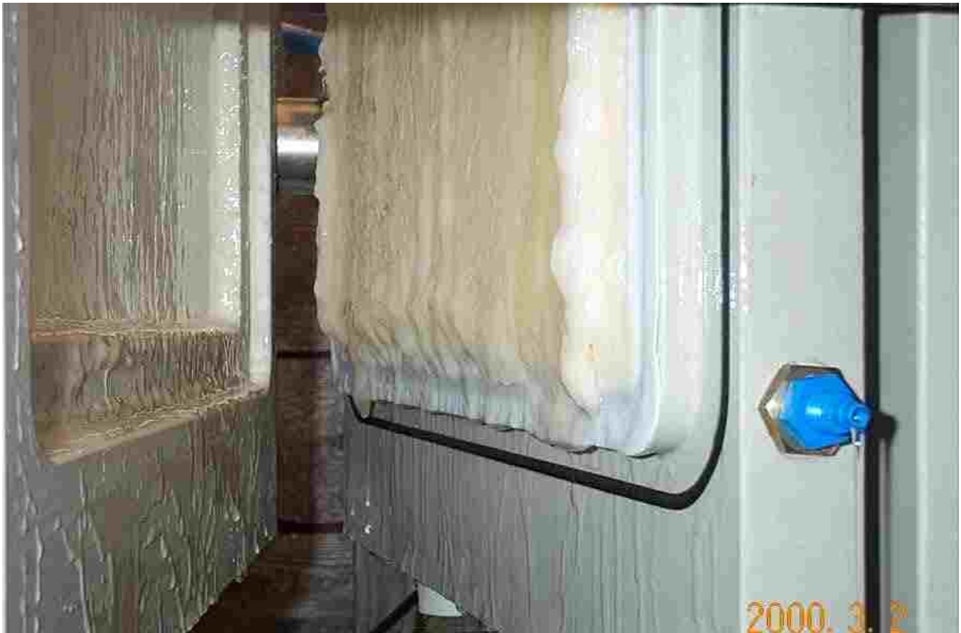
Elektrofiltration mit Xanthan in der Pilotanlage Symbiose250: Xanthan wurde deutlich als Filterkuchen auf der Anodenseite abgeschieden.
