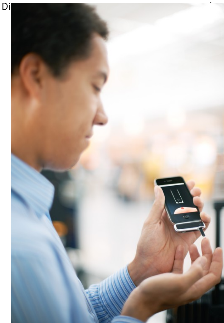
Mit Hilfe eines Adapters am iPhone kann der Blutzucker gemessen und an eine App übertragen werden.
