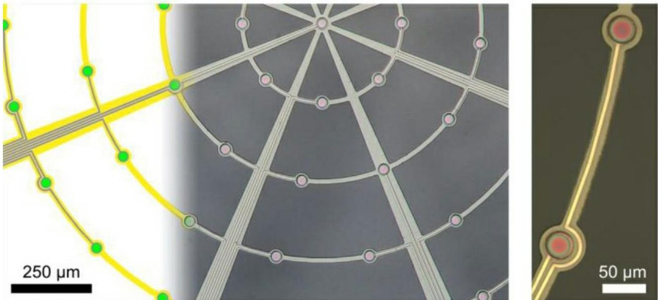
Links: Das spinnennetzartige hängende Mesh mit integrierten Mikroelektroden (grün) zeigt, dass die Regionen zwischen den Polymerfilamenten offen sind. Rechts: Zwei Mikroelektroden in einem einzelnen Filament.
