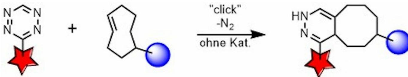
Mit Hilfe der Click-Reaktion können große komplexe Biomoleküle miteinander verbunden und etwa zu medizinischen Zwecken eingesetzt werden: Die Ausgangsstoffe Tetrazin und *trans*-Cycloocten werden mit Biomolekülen nach Wahl verknüpft - hier dargestellt als Stern (zum Beispiel ein Protein) und Kugel (zum Beispiel einem Farbstoff). In der Click-Reaktion entstehen aus den Ausgangsstoffen Bicyklen.
