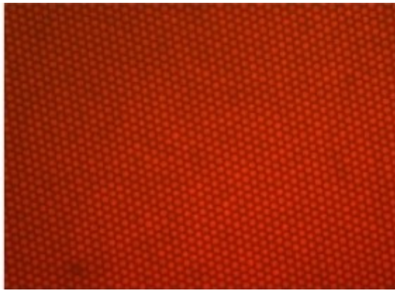
Links: Mikrosäulen mit einem Durchmesser von 10 Mikrometern und einer Höhe von 5 Mikrometern. Nach Funktionalisierung können so einfache Reaktionszonen aussehen. Rechts: Fluoreszenz-Aufnahme der Mikrosäulen mit fluoreszenzmarkiertem Protein © Rosenau/Kay Gottschalk/Uni Ulm
