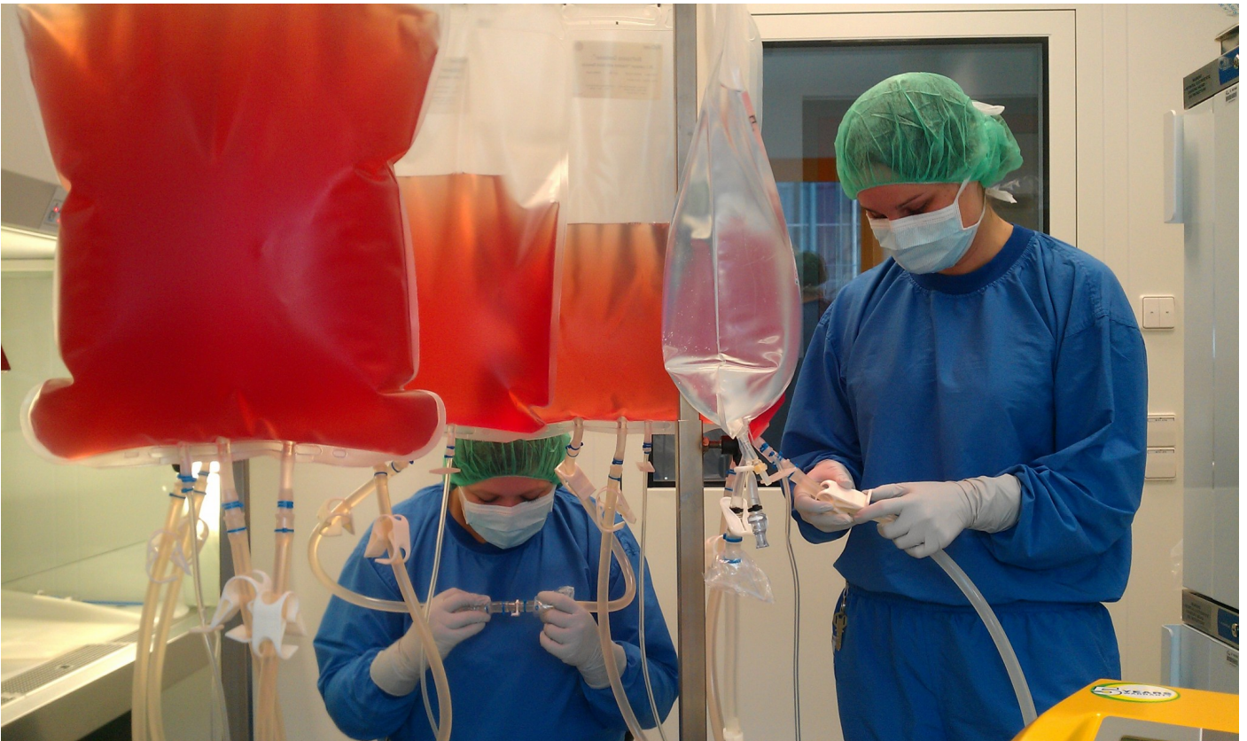
Zur Produktion des FLYSYN-Antikörpers wird speziell trainiertes GMP-Personal benötigt – hier sind zwei Mitarbeiter mit der sterilen Filtration beschäftigt. © SYNIMMUNE GmbH
