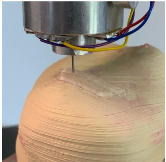
Forschende des SPI-MP haben eine Technik entwickelt, mit deren Hilfe künstlicher Kniegelenksknorpel personalisiert und der Natur nachempfunden per 3D-Druck hergestellt werden kann.
