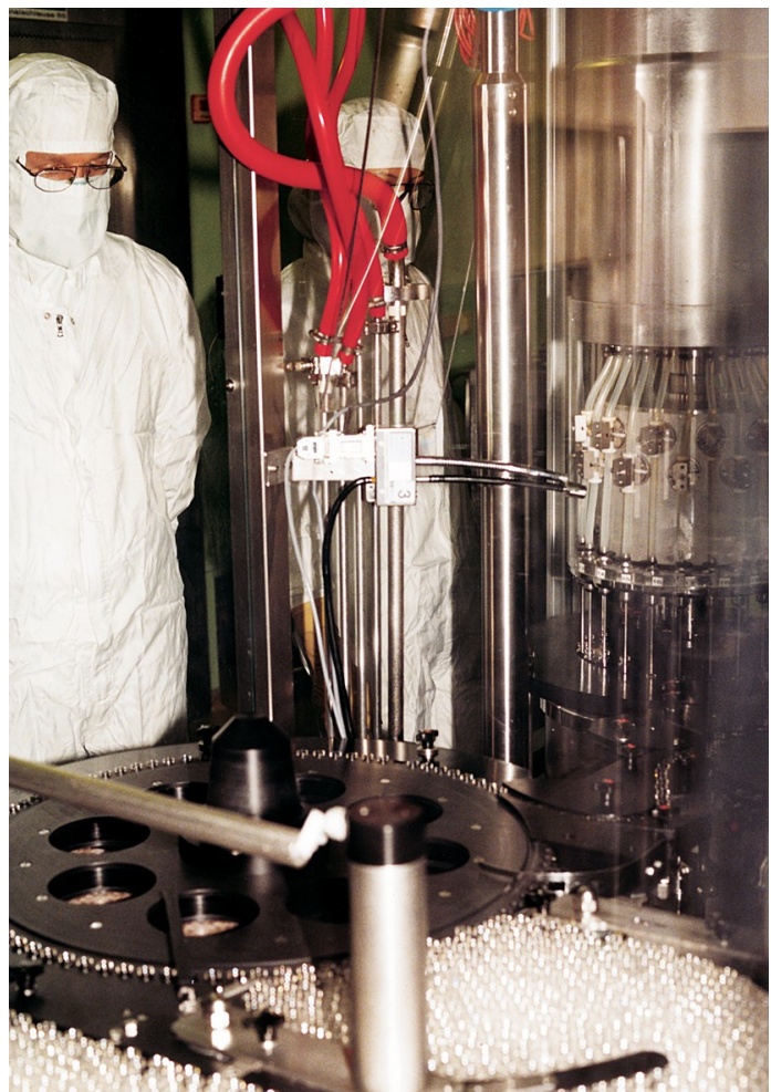
Konzerne wie Boehringer Ingelheim setzen längst auf Biologika. Im Bild ist die aseptische Abfüllung von biopharmazeutischen Produkten dargestellt. © Boehringer Ingelheim
