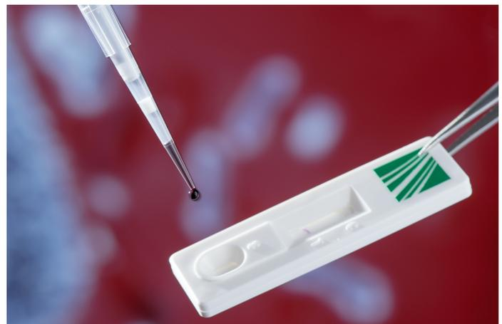
Der erste Prototyp des Pyrogen-Tests misst etwa zwei mal sechs Zentimeter.
