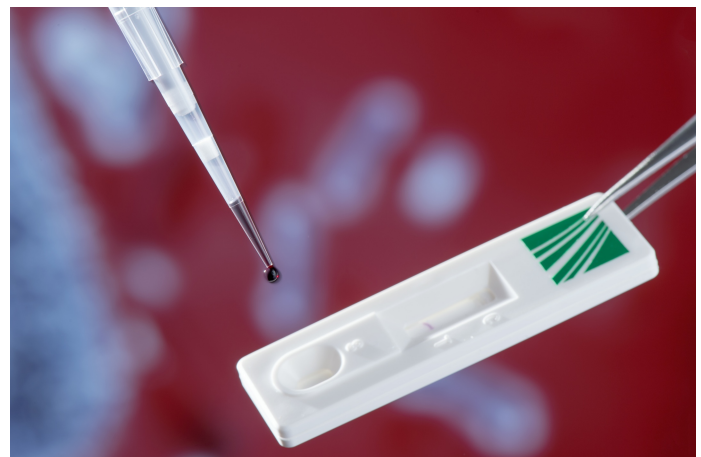
Der erste Prototyp des Pyrogen-Tests misst etwa zwei mal sechs Zentimeter. © Fraunhofer IGB
