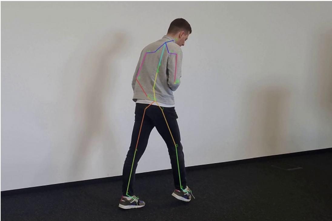
Das neue Messsystem des Förderprojekts SMARTGAIT ermöglicht eine automatisierte Erfassung von 3D-Skelettdaten mit dem Smartphone.
