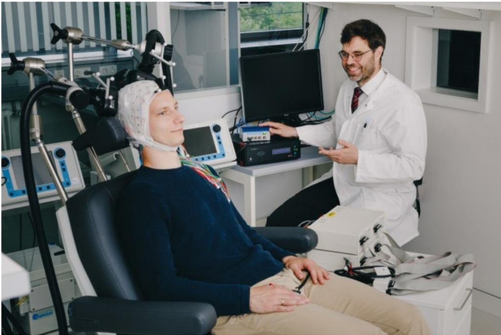
Bei der individualisierten TMS von sync2brain werden Hirnströme gemessen und die Magnetstimulation genau darauf abgestimmt. Hier zu sehen: Technisches Setup mit Gründer Dr. Christoph Zrenner, einem Mitarbeiter und dem bossdevice RESEARCH.
