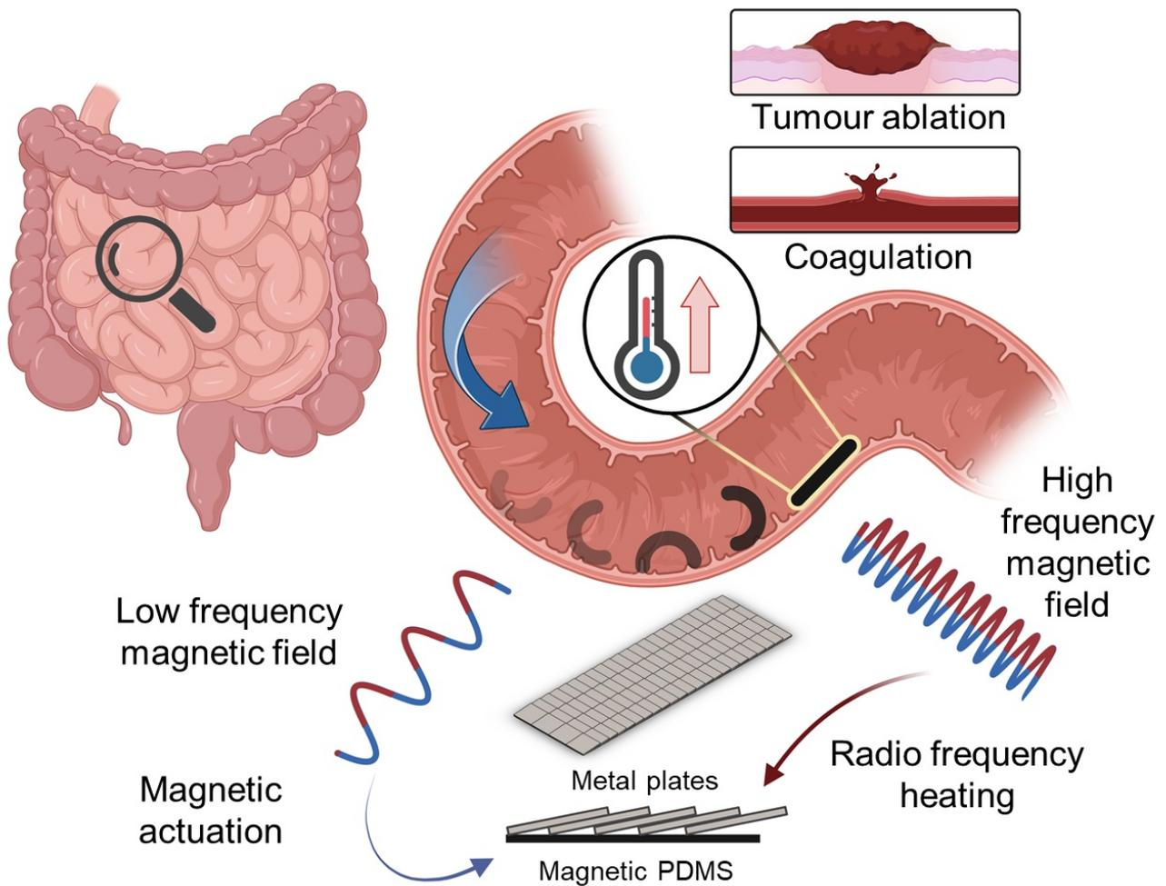
Schematische Darstellung der Funktionsweise des kabellosen Miniroboters im Dünndarm. Mit Hilfe eines niedrigfrequenten Magnetfeldes kann das Gerät gesteuert werden, hohe Frequenzen bewirken eine Erhitzung der Aluminiumplättchen, wodurch beispielsweise Blutungen gestoppt oder Tumore zerstört werden können. Quelle: <https://doi.org/10.1038/s41467-023-38689-x>, Ren Hao Soon, CC BY 4.0 (<https://creativecommons.org/licenses/by/4.0/>)
