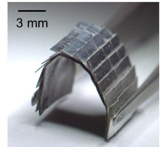
In Anlehnung an das Schuppentier besitzt der neuartige Roboter eine weiche Unterseite, auf der sich eine Schicht aus überlappenden, festen Metallplättchen befindet. Dieser Aufbau ermöglicht eine hohe Flexibilität. Quelle: <https://doi.org/10.1038/s41467-023-38689-x>, Ren Hao Soon, CC BY 4.0 (<https://creativecommons.org/licenses/by/4.0/>)
