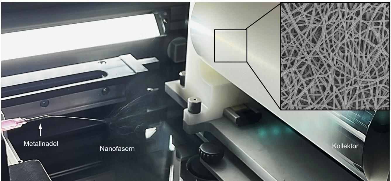
Beim Elektrosponnen wird das Fasermaterial unter Anlegen einer hohen Spannung von der Spitze einer Metallnadel (links) auf einen rotierenden Kollektor (rechts) gezogen und lagert sich dort als hauchdünner, endloser Faden ab (Vergrößerung oben rechts).
