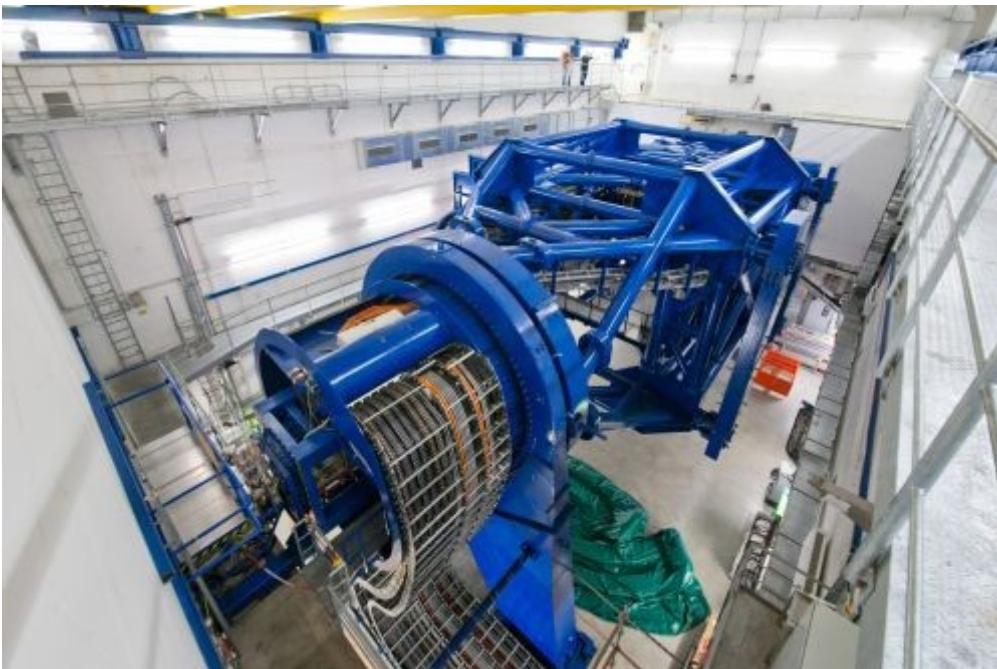
Die Strahlenkanone der Gantry im Heidelberger Ionenstrahl-Therapiezentrum, das größte Medizingerät zur Krebstherapie weltweit.
