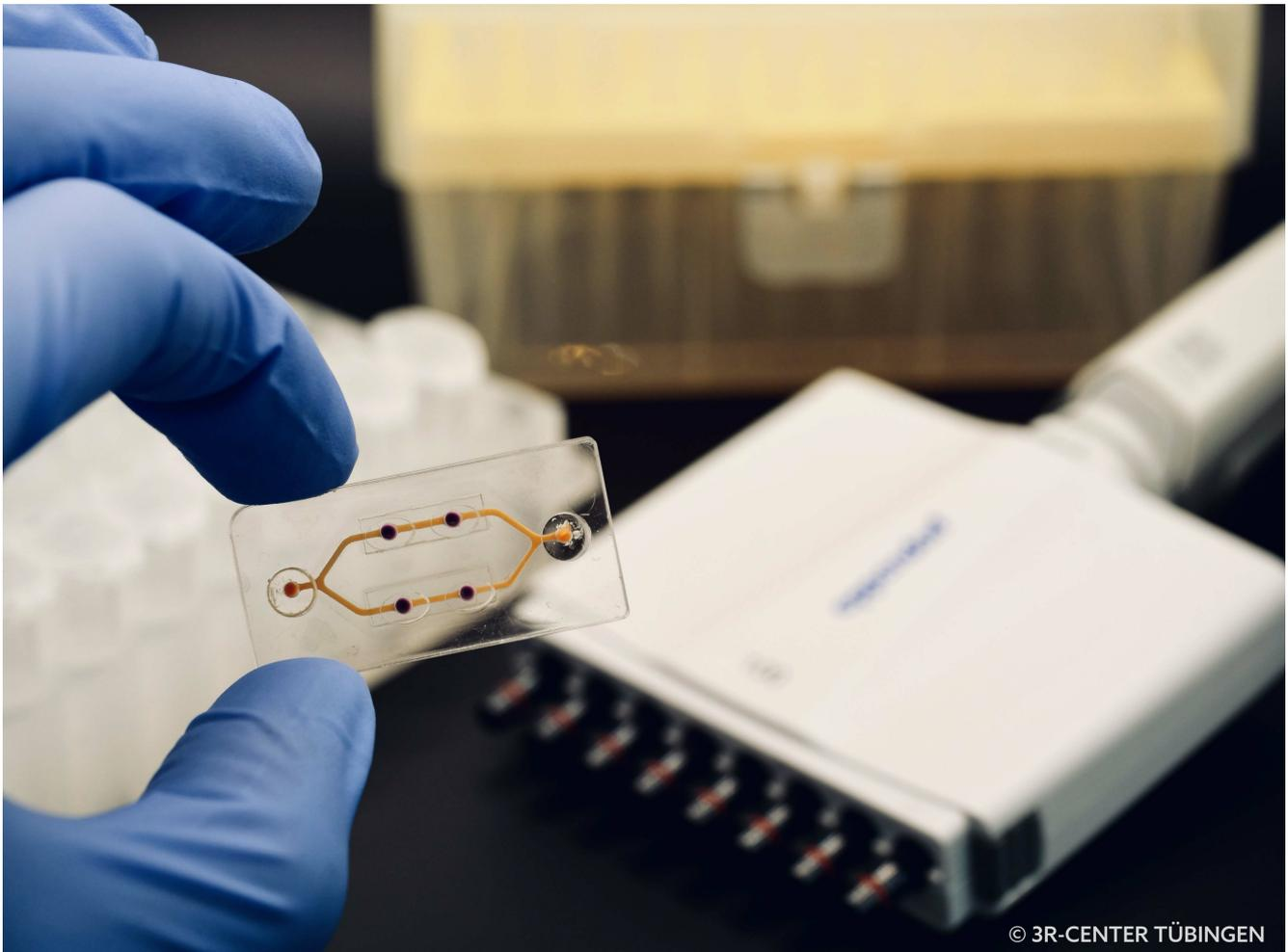
Auf dem Cervix-on-Chip ist das Modell eines Gebärmutterhalses entwickelt worden. Die Versorgung sowie der Abtransport von Stoffen ist durch die kleinen Kanälchen gewährleistet.
