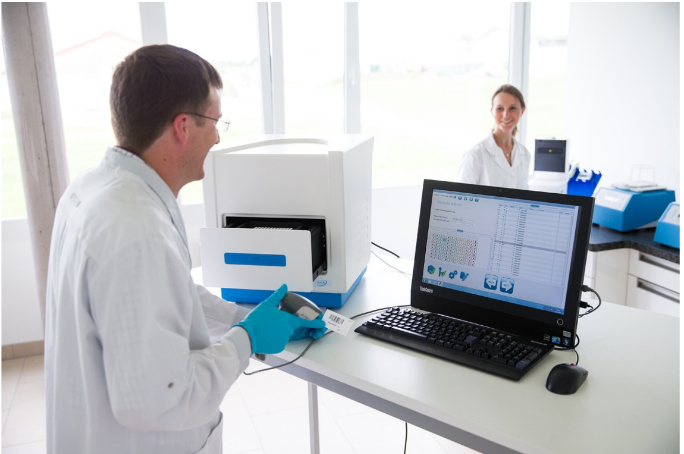
Der PCR-basierte FluoroType Bordetella weist nach etwa drei Stunden die beiden Keuchhusten-Erreger Bordetella pertussis und parapertussis direkt aus der Patientenprobe nach. © Hain Lifescience GmbH
