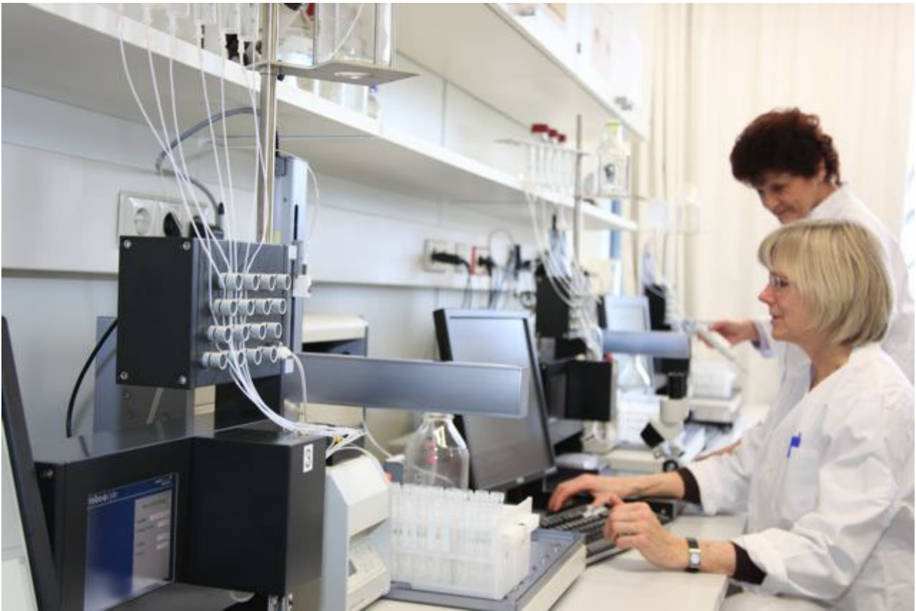
Die NMI TT GmbH setzt automatisierte elektrophysiologische Verfahren, zum Beispiel mit dem "Roboocyte", ein, um medizinische Wirkstoffe zu testen. © NMI TT GmbH
