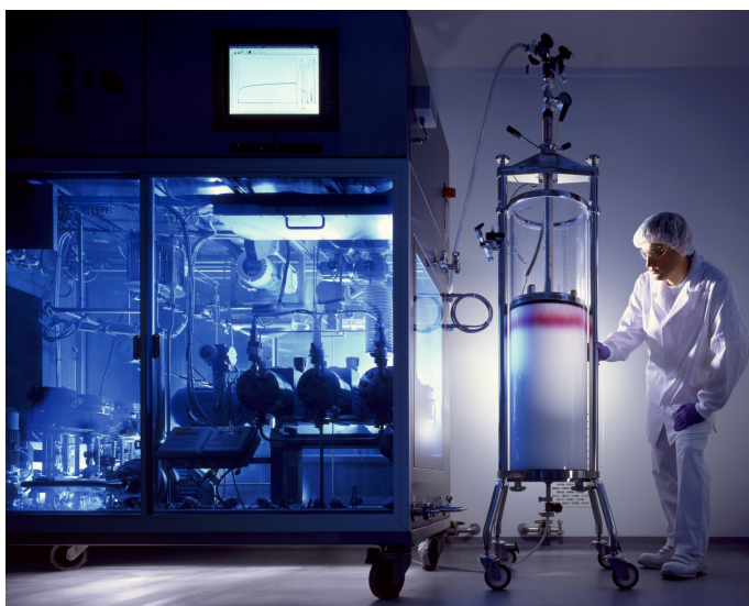
Herstellung von Biopharmazeutika am Standort Ulm – Chromatographiesäule zur Aufreinigung von biopharmazeutischen Proteinen.
